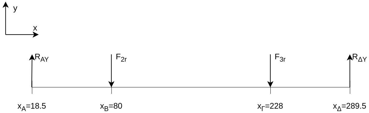
Σχήμα 3: Διάγραμμα Ελευθέρου Σώματος ενδιάμεσου άξονα στο επίπεδο xy
