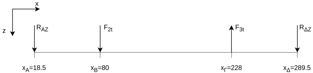
Σχήμα 2: Διάγραμμα Ελευθέρου Σώματος ενδιάμεσου άξονα στο επίπεδο xz
